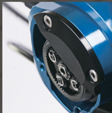
Präzise Gangindexierung im Getriebe ist unanfällig gegenüber Zuglängung. Deswegen ist keine Nachjustierung der Schaltung nötig. // *Precise gear indexing in the gearbox is insusceptible to tensile elongation of the shift cable. Thus, no readjustment of the system is necessary.*
