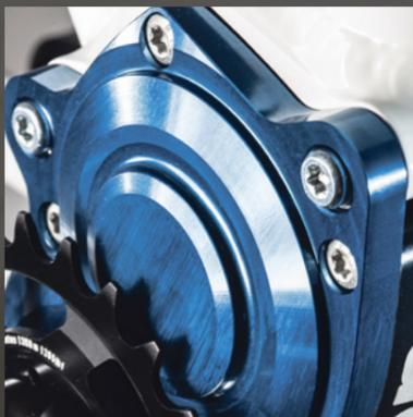
Höchste Laufleistungen durch gedichtete Bauweise mit 60ml Öltauschmierung. Außer einem Ölwechsel alle 10.000 Km sind am Getriebe keine weiteren Wartungsarbeiten erforderlich. // *Highest mileage through sealed construction with 60ml oil bath lubrication. Apart from an oil change every 10.000 km, no further maintenance is required on the transmission.*
