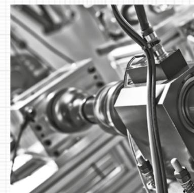
60.000+ km werden in weniger als 2 Wochen durch hochgerechnete Lasten, sprich Lastkollektive, getestet. // *60.000+ km of used simulated in under 2 weeks of compressed testing.*
