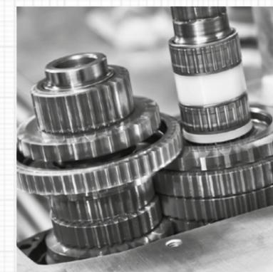
Stationärbetrieb: 300 Stunden unter maximaler Belastung ergeben 3,6 Millionen Be- und Entlastungen jedes einzelnen Zahns. // *Stationary mode: 300 hours giving 3.6 million load/unload cycles for each tooth.*
